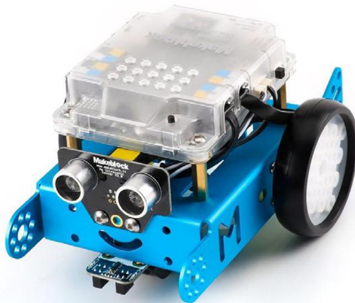
3.7 | mBot, in posa. Si riconoscono i sensori di distanza (sonar) che sembrano gli "occhi" dell'automobile e il sensore di linea, sporgente sotto. Nell'involucro semitrasparente è ospitata la scheda Arduino per il controllo dei vari componenti e sensori
